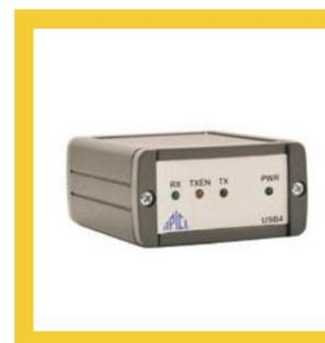
Convertitore seriale da USB a RS485. E' il componente ideale per collegare un PC a una rete RS485. Dopo l'installazione dei driver può operare fino ad una velocità di 250 Kbaud e non ha bisogno di alimentazione esterna poiché si alimenta direttamente dalla porta USB. La linea RS485 è isolata a 2500 VRMS verso il PC per un'efficace protezione contro le differenze di potenziale di modo comune.
