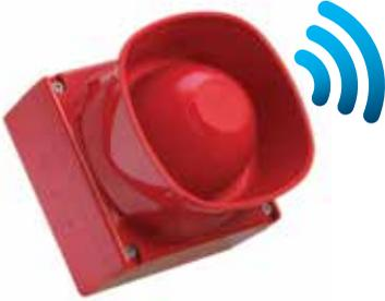
Il monitoraggio del suono riflesso o RSM viene utilizzato per monitorare l'audio degli avvisatori acustici. La tecnologia consente al prodotto di misurare il proprio segnale acustico tramite un microfono integrato. Quando si attiva questo avvisatore acustico è in grado di comunicare il proprio stato di funzionamento, eliminando quindi la necessità di svolgere il test in presenza di un tecnico.
