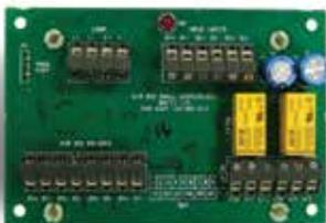
Il modulo ingresso/uscita multiplo FC410MIO presenta tre ingressi e due uscite da relè di blocco. Gli ingressi possono monitorare i contatti incendio come quelli che controllano il sistema di estinzione, la ventilazione e le porte antincendio. Le due uscite relè forniscono contatti relè in scambio senza tensione.
