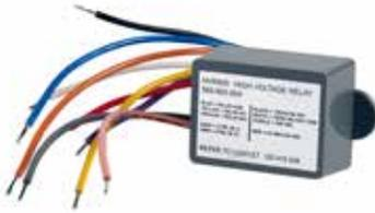
L'interfaccia relè ad alta tensione HVR800 è un modulo relè multitemperatura non indirizzabile (con funzionamento da 24 Vcc, 24 Vca, 120 Vca e 240 Vca). L'unità incapsulata HVR800 fornisce un contatto senza tensione da 10 A che può essere utilizzato per ampliare la portata dei contatti nelle applicazioni che impiegano il modulo relè indirizzabile FC410RIM.
