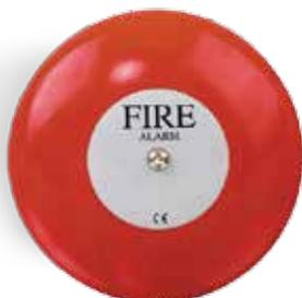
Le campane antincendio, progettate appositamente per resistere alle intemperie, hanno una scatola da incasso in alluminio e offrono un ingresso a filettatura singola o doppia per garantire la massima flessibilità di installazione. Il prodotto viene fornito con un kit di montaggio completo che include viti e guarnizione.
