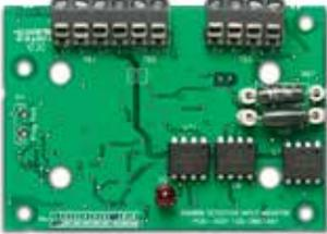
Il modulo indirizzabile FC410DIM offre la possibilità di collegare e interfacciare una zona di rilevatori convenzionali (non indirizzabili) alla centrale antincendio. Il modulo FC410DIM monitora lo stato e il cablaggio dei rilevatori, segnalando il loro stato alla centrale. Richiede un'alimentazione a 24Vcc.
