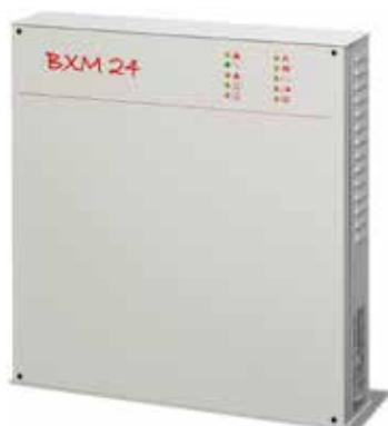
Le unità BXM24/25-U e 50-U sono approvate dall'IMQ secondo le norme EN 54-4:1997 + A1:2002 e EN60950-1:2001. L'alloggiamento in acciaio contiene un alimentatore a commutazione da 2,5 A o 5 A e la scheda di monitoraggio. Inoltre, offre spazio a sufficienza per due batterie al piombo da 12 V 17 Ah. I 10 LED del pannello frontale indicano in modo completo lo stato dell'unità di alimentazione.
