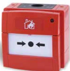
Punto di chiamata manuale resistente alle intemperie con LED di allarme integrato e resistore di attivazione. Si attiva mediante rottura del vetro. Questo punto di chiamata viene montato a vista ed è fornito con scatola da incasso e chiave di test.
