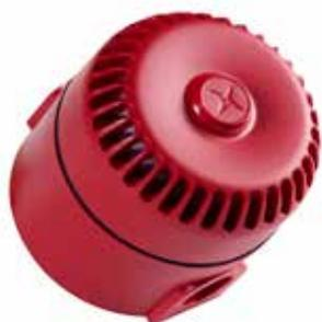
Avvisatore acustico flessibile per sistemi antincendio e di sicurezza, dotato di controllo del volume e 32 toni selezionabili mediante interruttore DIL. Il dispositivo Roshni a basso profilo con base alta offre un grado di protezione IP65. Tutti gli avvisatori acustici Roshni si avviano in modo sincronizzato per garantire l'auto-sincronizzazione senza un terzo cavo.
