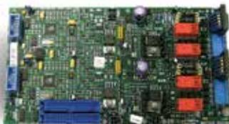
Il modulo di espansione loop XLM800 si utilizza per integrare due loop aggiuntivi nelle centrali indirizzabili FC64 e FC240, che potranno quindi supportare 4 loop, ciascuno con un massimo di 250 indirizzi. Queste unità sono di serie nelle centrali FC64-4 e FC240-4.
