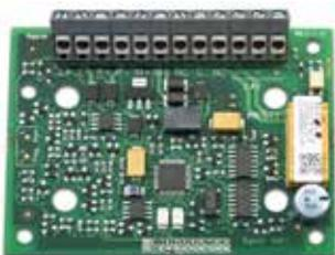
Se attivato da un segnale di incendio, un guasto o un'avaria nella zona della porta antincendio, il modulo FC410TSM interromperà l'alimentazione ai dispositivi che tengono aperte le porte controllate dal modulo, determinandone la chiusura. Il modulo è predisposto per monitorare un contatto e segnalare alla centrale antincendio eventuali problemi di chiusura della porta. Inoltre, è dotato di un isolatore di linea integrato.
