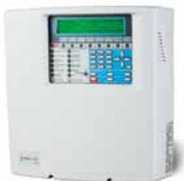
Centrale con loop singolo a triplo circuito, supporta fino a 128 dispositivi loop. La mascherina contiene stringhe di testo in lingua inglese. Unità di alimentazione da 2,7 A.
