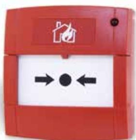
Punto di chiamata manuale convenzionale con LED di allarme integrato e resistore di attivazione. Si attiva mediante rottura del vetro. Questo punto di chiamata può essere montato a semi-incasso oppure a vista utilizzando la scatola 515.001.021 o 10-115 ed è completo di chiave di test.
