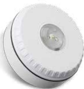
L'avvisatore ottico da soffitto Solista LX è dotato di una lente dal design esclusivo che distribuisce la luce in modo cilindrico per ottenere l'illuminazione richiesta specificata dallo standard EN 54-23. Progettato per essere installato fino a 3 metri di altezza e con un aspetto discreto, il dispositivo è ideale per varie applicazioni.
