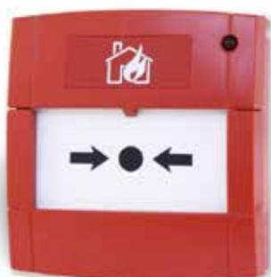
Il pulsante di allarme indirizzabile per interni FC420CP-I è progettato per monitorare e segnalare lo stato di un contatto di commutazione generato dall'attivazione dell'elemento deformabile in plastica. Isolatore di cortocircuito integrato.
