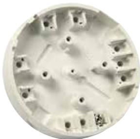
La base montaggio Euro fornisce una scatola da incasso che permette di montare a soffitto le basi da 5" con ingressi per condotti standard da 18 e 21 mm.
