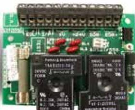
Il modulo booster avvisatore acustico SB520 consente al modulo FC410SNM di alimentare circuiti con correnti più elevate e mantenere allo stesso tempo il monitoraggio di linea dell'integrità della polarità inversa. Non è indirizzabile e richiede un alimentatore locale da 24 Vcc per alimentare un unico circuito di avvisatori acustici polarizzati e soppressi.
