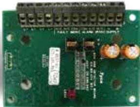
Il modulo di raccordo per rilevatori lineari FC410BDM è progettato per alimentare e interfacciare un rilevatore lineare FIRERAY 50/100/5000 al loop digitale indirizzabile FireClass.
