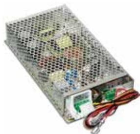
Le serie di alimentatori BAW e BAQ forniscono una tensione regolata in uscita pari a 27,6 V e valori di corrente che vanno dai 1,8 A a 5,5 A. L'uscita degli alimentatori BAW e BAQ è protetta contro il sovraccarico, i cortocircuiti e l'inversione accidentale della polarità delle batterie.
