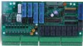
Il modulo di espansione ingresso/uscita IOB800 è una scheda approvata da LPCB che fornisce 8 ingressi digitali optoisolati e 8 uscite relè 24 Vcc. Questo modulo consente di espandere il numero di ingressi e uscite delle centrali FireClass per interfacciarle ad altri sistemi di protezione e dispositivi di segnalazione. Il modulo IOB800 può essere controllato dalla centrale o tramite il bus remoto.
