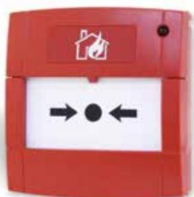
Punto di chiamata manuale convenzionale con LED di allarme integrato e resistore di attivazione. Si attiva tramite un elemento deformabile e ripristinabile. Questo punto di chiamata può essere montato a semi-incasso oppure a vista utilizzando la scatola 515.001.021 o 10-115 ed è completo di chiave di test.
