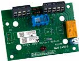
Il modulo ingresso/uscita singolo FC410SIO è progettato per fornire un ingresso a collettore aperto e un'uscita relè in scambio senza tensione. FC410SIO è in grado di commutare fino a 2 A a 24 Vcc.
