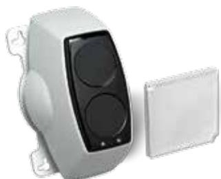
FireRay® 50 e FireRay® 100 sono composti da due elementi di base, ovvero un'unità combinata, costituita da un trasmettitore a infrarossi e un ricevitore collocati in un contenitore comune, e un prisma riflettente. L'elettronica dell'unità trasmettitore/ricevitore permette di analizzare il fascio riflesso dal prisma a causa del fumo e genera una condizione di allarme al raggiungimento di un livello predeterminato.
