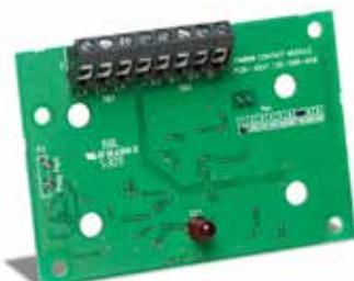
Il modulo di ingresso per contatti indirizzabili FC410CIM è progettato per monitorare contatti incendio come quelli che controllano il sistema di estinzione, la ventilazione e le porte antincendio. Può essere configurato nelle seguenti modalità:
