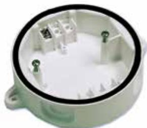
Per il montaggio dei rilevatori in condizioni ambientali problematiche o in presenza di umidità, ad esempio nelle installazioni del settore marino e offshore, la base di montaggio stagna 4B DHM garantisce un'installazione ermetica e impermeabile che protegge i collegamenti elettrici della base. Può essere avvitata, imbullonata o saldata al soffitto. Viene fornita con 1 terminale. Se sono necessari ulteriori terminali, è possibile acquistare il kit supplementare opzionale.
