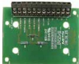
In molti casi sarà necessario collocare il modulo per rilevatore lineare FC410BDM a una certa distanza dal rilevatore lineare stesso. In questi casi, per minimizzare e semplificare il cablaggio è disponibile l'unità opzionale BTM800, ovvero un modulo terminale per rilevatori lineari.
