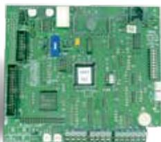
Il modulo MPM800 fornisce varie opzioni di espansione tramite il bus remoto (RBUS).
