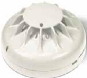
A completamento della gamma è disponibile il sensore termico, che può funzionare sia a soglia di temperatura fissa sia come rilevatore termovelocimetrico. Trova largo impiego nelle aree in cui sono presenti livelli elevati di polveri o dove l'ambiente preclude l'utilizzo di rilevatori di fumo.
