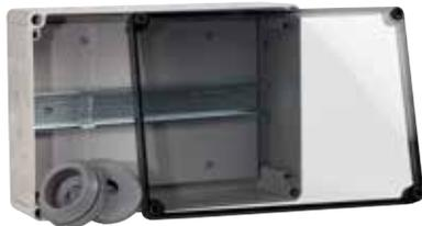
Alloggiamento in polistirene/polycarbonato con grado di protezione IP66, dotato di guida DIN per il montaggio di un modulo ingresso/uscita quadruplo (FC410QIO) o 1 modulo a quattro uscite monitorate (FC410QMO) o 1 modulo relè quadruplo (FC410QRM), completo di coperchio anteriore trasparente.
