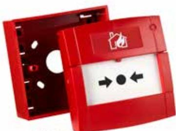
Punto di chiamata manuale convenzionale con LED di allarme integrato e resistore di attivazione. Si attiva tramite un elemento deformabile e ripristinabile. Il prodotto viene fornito con scatola da incasso e chiave di test.
