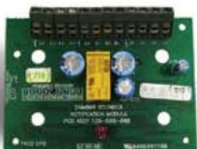
Il modulo di notifica avvisatore acustico FC410SNM è progettato per fornire un'uscita, controllata da un comando inviato da una centrale, che consente di attivare una serie di avvisatori acustici polarizzati e soppressi. Gli avvisatori acustici sono provvisti di un alimentatore indipendente e il modulo è in grado di commutare un carico fino a 2A (es. avvisatori acustici aziendali a 24Vcc a 50mA o un mix di avvisatori acustici con correnti nominali diverse complessivamente non superiori a 2 A).
