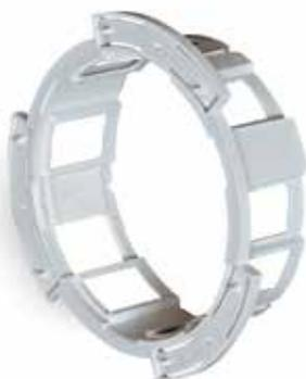
L'adattatore per controsoffitti (CTA) con sistema salvatempo viene usato con la base rilevatore 4B da 4" con meccanismo a scatto ed è formato da tre parti: una cornice e un morsetto che vengono fissati sul pannello a soffitto e una scatola che alloggia il gruppo rilevatore e base.
