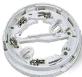
La 4B-I è la nuova base da 4" con isolatore. Si aggancia all'adattatore per pannelli a soffitto tramite meccanismo a scatto o può essere fissata al soffitto con viti tradizionali. La base 4B-I da 4" è progettata appositamente per l'utilizzo con i rilevatori della FC460 e fornisce protezione contro i cortocircuiti sul loop digitale indirizzabile.
