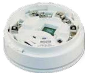
La base relè della serie 600 fornisce contatti a doppio relè per i dispositivi di segnalazione esterni installati su sistemi di rilevazione convenzionali. Il bassissimo livello di corrente utilizzato per il funzionamento, anche quando il relè viene alimentato, consente di utilizzare la base relè senza ulteriore energia. I contatti relè si attivano quando il rilevatore entra in stato di allarme.
