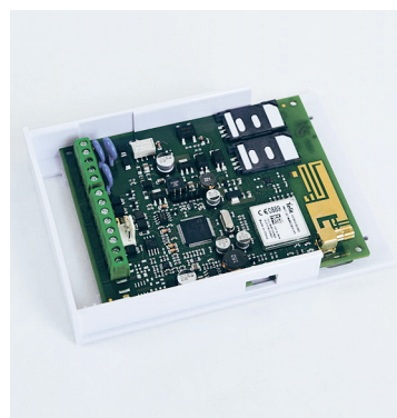
alloggio della scheda nel contenitore slim
