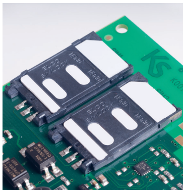
alloggiamento delle 2 SIM cards
