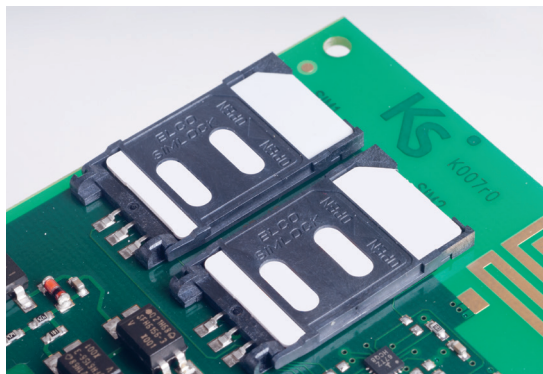
alloggiamento delle 2 SIM cards per 2 diversi operatori
