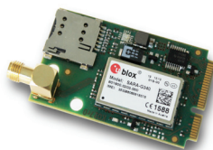
A modulo add-on GSM/GPRS (modulo U-Blox radio)
